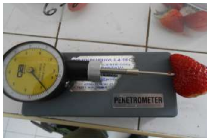
Figura 19. Penetrómetro para determinar firmeza de fresa con el punzón de 6 mm.
