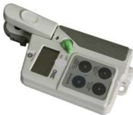
Figura 20. Aparato para determinar lecturas SPAD
