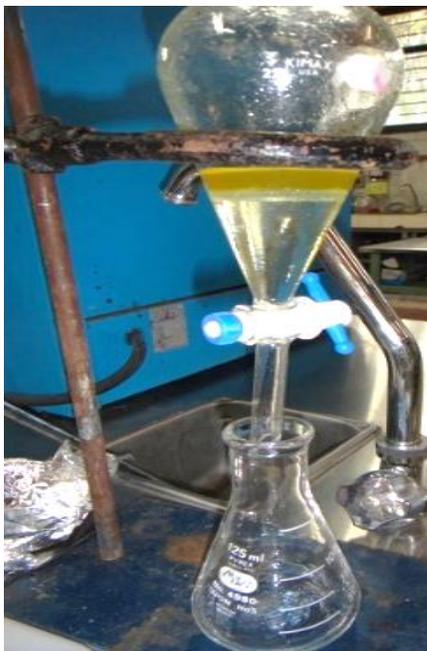
**Figura 13.** Proceso de extracción de la fase orgánica en muestras de *Lupinus*. Fotografía de Nuñez-Gavica KM.
