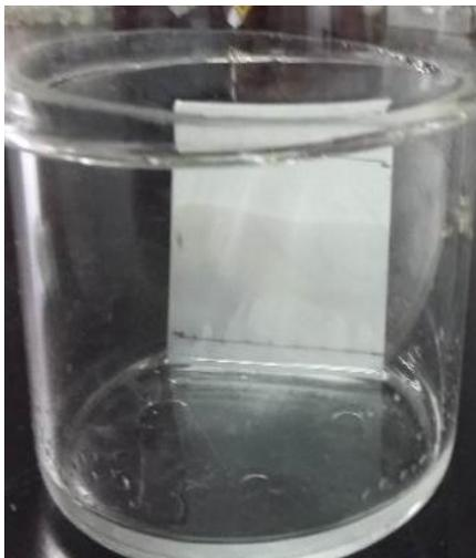
**Figura 14.** Cámara de vidrio para cromatografía en capa fina. Fotografía de Nuñez-Gavica KM.
