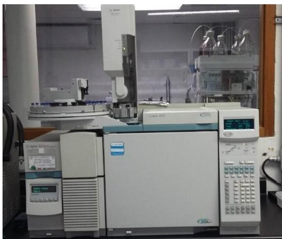
**Figura 15.** Cromatógrafo de Gases Agilent Technology® modelo 6890 plus, acoplado a un espectrómetro de masas 5973N. Fotografía de Nuñez-Gavica KM.
