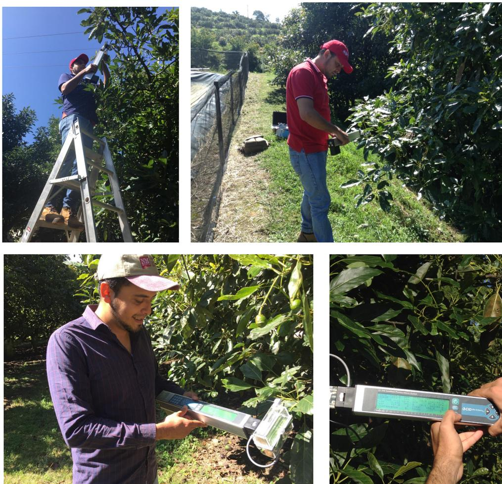
Figura 22. Determinación de intercambio de gases mediante sistema portátil al infrarrojo.
