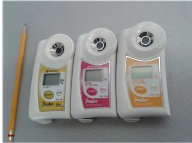
Figura 4. Refractómetros para la determinación de Grados brix, Vitamina C, e Inulina.
