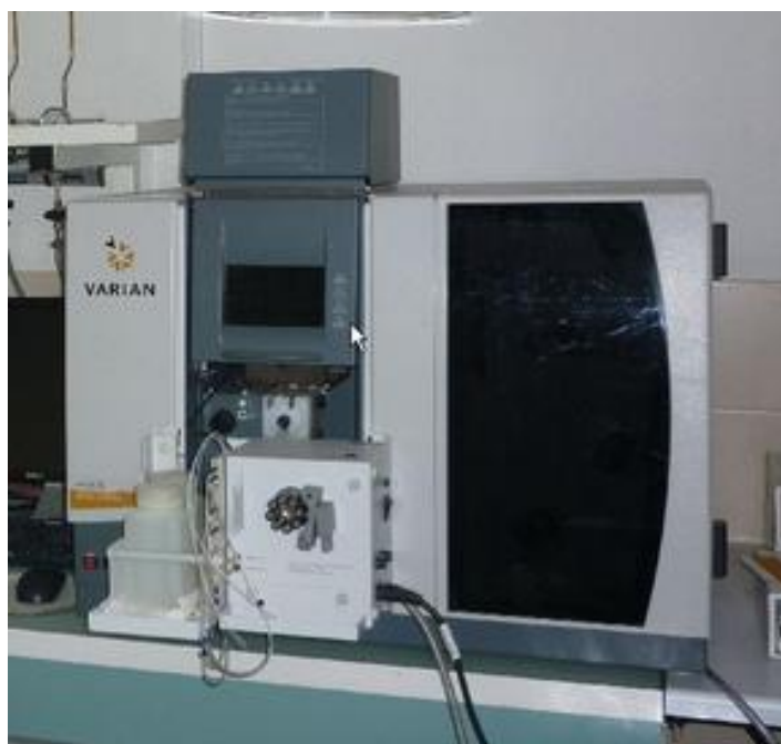
Figura 2: Espectrofotómetro de Absorción Atómica del Laboratorio de Ciencias Ambientales del Centro Universitario de Ciencias Biológicas y Agropecuarias (CUCBA).
