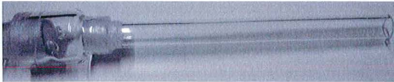
Figura 5. Dispositivo similar al de Ardeh et al., (2004) utilizado en bioensayo de volátiles. Foto: MC Velasco H.
