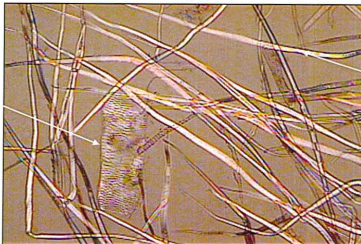
Figura No. 19, Fibras y elementos de vasos obtenidos mediante el proceso de cocción a la sosa.
