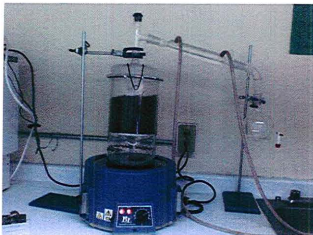
Figura 4. Extractor de aceites esenciales por el método de arrastre de vapor.
