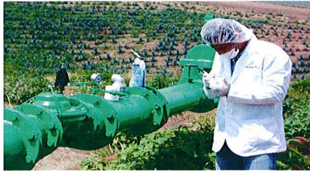
Figura 7. Toma de muestra de agua para la determinación de coliformes fecales, totales y E. coli . (Luna y Huitrón, 2007).
