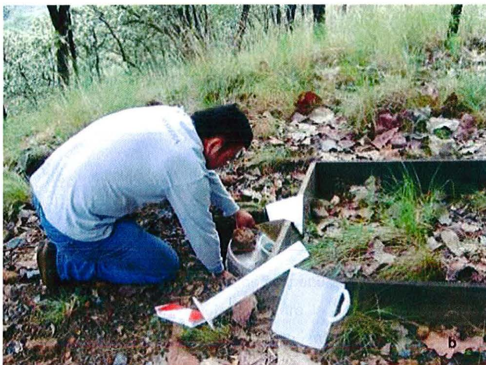
Figura 8. Medición de parámetros de precipitación y escurrimiento.
