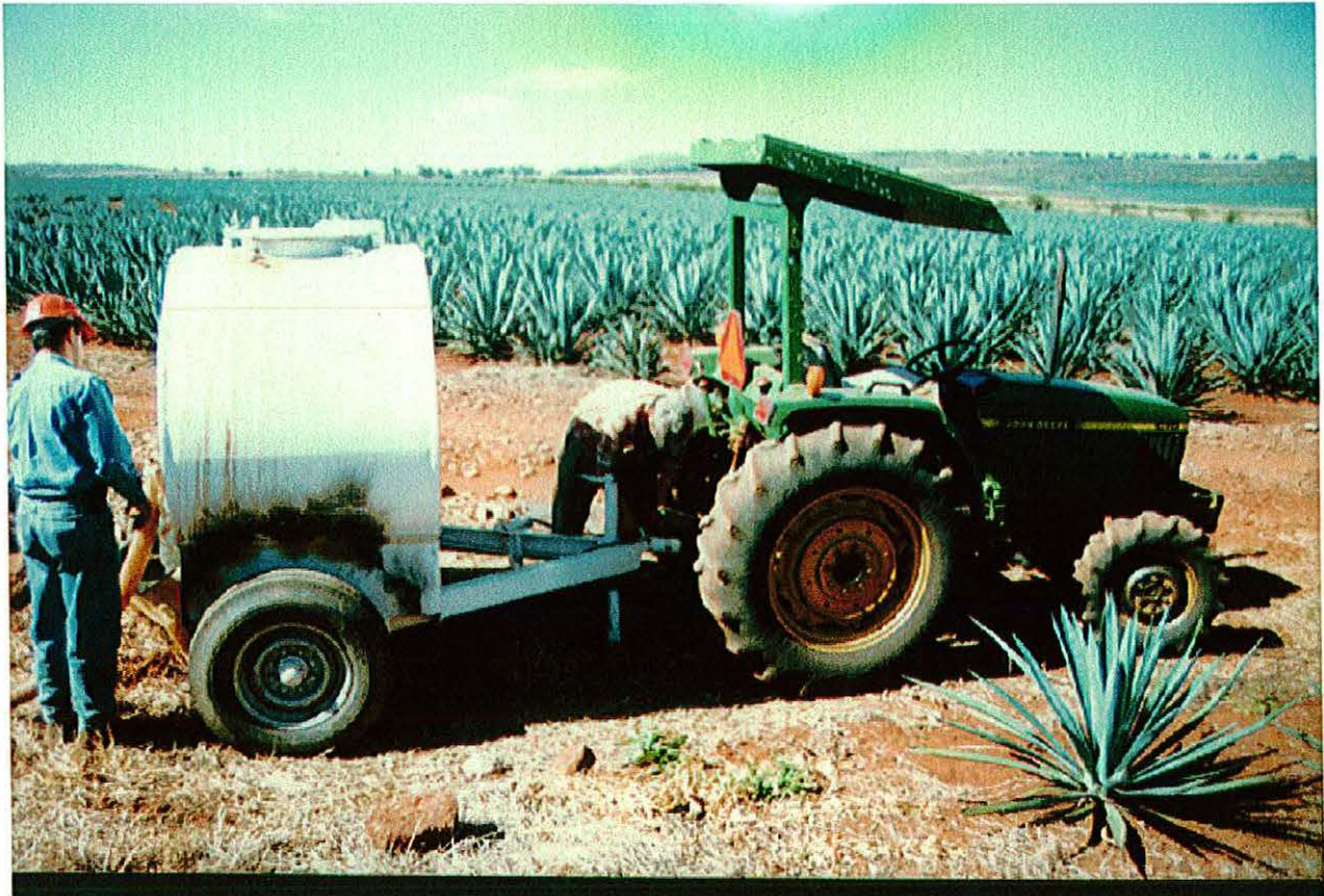
Figura 3. Pipa de 2,000 l (2 m 3 ) para la aplicación de vinaza en las unidades experimentales.
