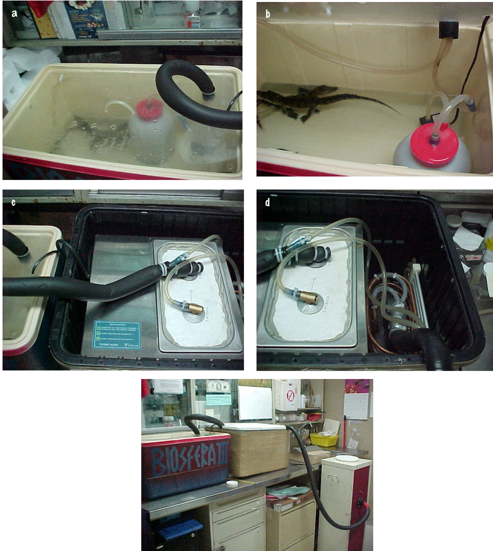
Figura 21. Albergue para cocodrilos con temperatura controlada. a) Albergue para cocodrilos; b) Interior del albergue para cocodrilos con temperatura controlada; c y d): Sistema de control de temperatura; e): Vista general del albergue para cocodrilos con temperatura controlada.
