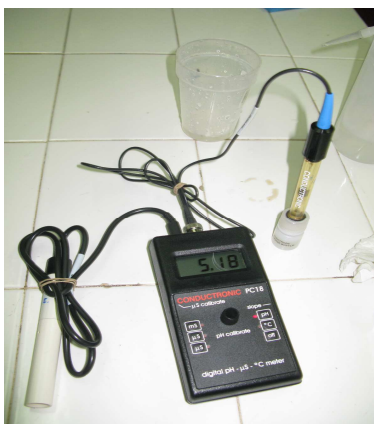
Figura 4. Potenciómetro y conductímetro para medir pH y CE
