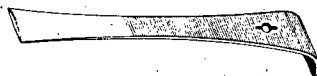
Figura No. 14 La espátula llamada también cuña, es usada para separar alzas y cuadros, para separar cera y propóleos, sacar clavos y hasta como martillo.
